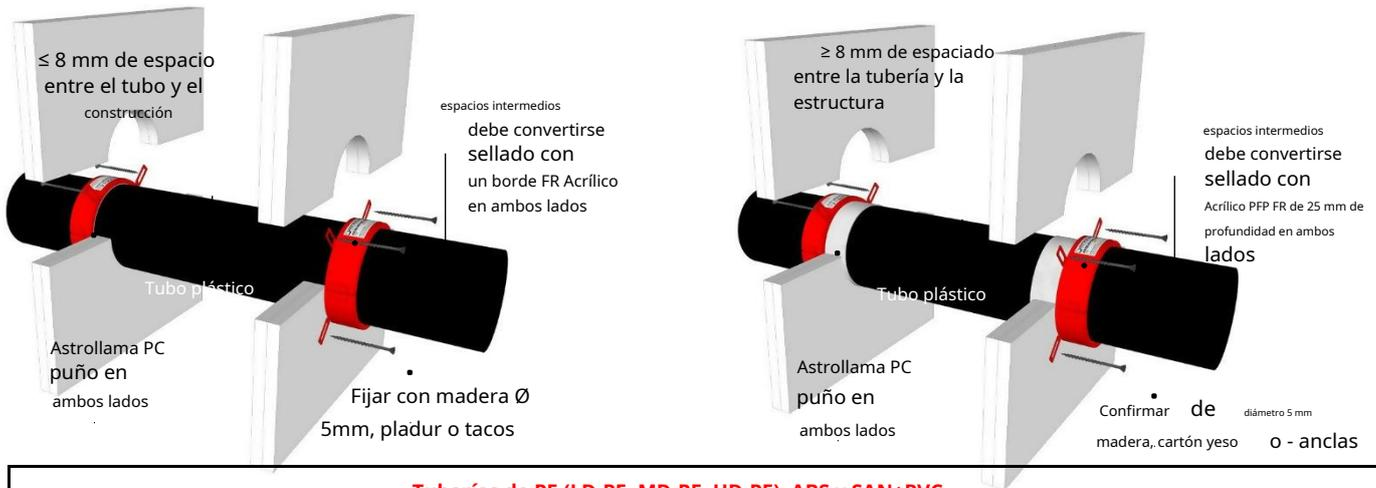
**Tuberías de PE (LD-PE, MD-PE, HD-PE), ABS y SAN+PVC**
