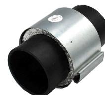
Die Hülse MT1 wird um den synthetischen Schlauch gelegt. Er muss eingelassen sein. Leichte Platzierung durch Abtragen der Rutsche, Öffnung der Muffe, Platzierung auf dem Schlauch und Neuverlegung der Rutsche. Der Freiluftdurchgang beträgt 100% und der Feuerwiderstand kann bis zu 120 min betragen.
